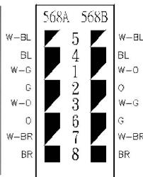
Die einzelnen Adern mit dem LSA-Werkzeug (Best.Nr.: HKRONELSA) entsprechend Farbcodes 568A oder 568B auflegen und kürzen. / Install and cut the wires according to color code 568A or 568B with the punch down tool (Order No.: HKRONELSA).
