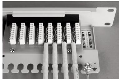
Zur Zugentlastung das Kabel mit Kabelbindern am Kamm befestigen. / For strain relief fasten the cable to the patchpanel tabs by use of cable-ties.
