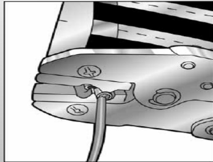
Kobl sammen folielengdene med de medfølgende dobbeltisolerte RKK-kablene. Fjern ca. 6 mm av isolasjonen, og stikk kablene inn i koblingsklemmen. Når det bare er én kabel, brettes den avisolerte delen dobbelt, som vist i figur.
